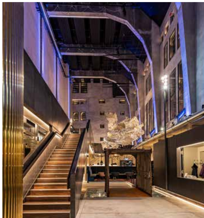
Abb.: Für die Farbpalette der Raumschale und Inszenierung der »Lichtwolke« werden die RGB-Strahler auf DMX-Basis angesteuert. Die DMX-Steuerung wird entweder über das KNX-Gateway mitgesteuert oder kann von einer unabhängigen DMX-Steuerung, z. B. in die Veranstaltungstechnik, integriert werden. Foto: Eckhart Matthäus Fotografie
